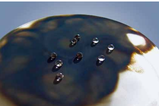
Lotuseffekt: Wassertropfen auf einer beruhten Petrischale.
